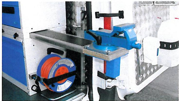
*Výsuvný svěrák přijde vhod při drobných zámečnických a jiných pracích*
